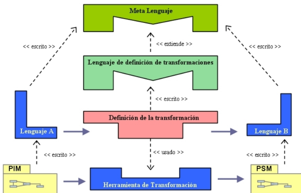
Figura 5-4. Esquema de transformación M2M
