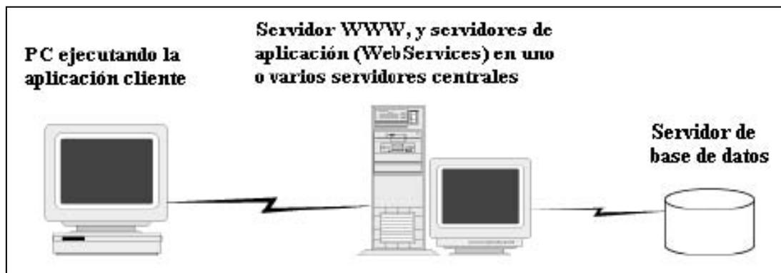
Fig. 1 Esquema de la programación en tres capas
